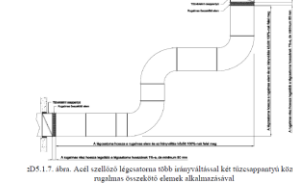
2D5.1.7. ábra. Acél szellőző légszatórna több irányváltással két tűzcsappantyú között rugalmas összekötő elem alkalmazásával
