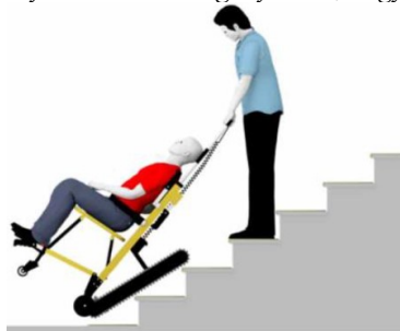
5B ábra: Az evakuációs szék használatának elvi bemutatása
