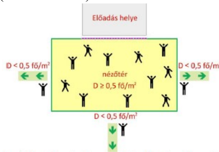
6. ábra: A kezdeti szabad menekülési szélesség zöld vonallal szemléltetve (az első számítási metódushoz kapcsolódó ábra)
