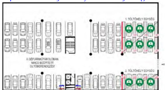
17. ábra – Példa a töltőhelyek kialakítására a b) pontban rögzített feltételek teljesülése esetén és a töltési pontonkénti teljesítmény nem haladja meg a 22 kW-ot
