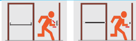
7C ábra: 4MSZ EN 1125 szerinti pánikajtózár (panic exit device) lenyomós rúddal illetve benyomós rúddal
