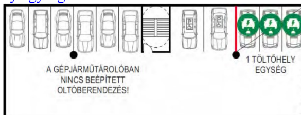
22. ábra – Példa a töltőhelyek kialakítására a d) pontban rögzített feltételek teljesülése esetén Megjegyzés 1:
