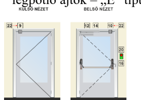
G21. ábra: Egyszárnyú, elektromos zárással rendelkező homlokzati ajtók / tűzgátló vagy légpótló ajtók – „E” típus
