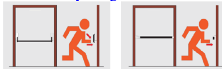
7C ábra: 4MSZ EN 1125 szerinti pánikajtózár (panic exit device) lenyomás rúddal illetve benyomás rúddal
